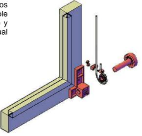
El cable debe pasar en la parte superior por detrás del perno con rodamiento y aro guarda cable superior de freno (Ver fig. 11)
