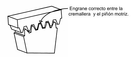
2) Una vez fijado el mecanismo proceda a la colocación de la cremallera en todo el ancho del portón dejando 2mm de luz entre piñón y cremallera, teniendo en cuenta que la misma esté perfectamente nivelada. Dicha cremallera se fijara al zócalo del portón, soldando la base de la misma con puntos cortos de soldadura cada 500 mm
