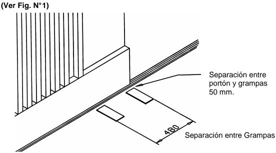
El segundo paso, se tendrá que llegar al centro de las grampas previamente amuradas con corriente trifásica ( 3 cables x 2.5mm, más neutro y maza. Desde ésta ubicación también habrá que llevar el cableado para la botonera ( 4 cables x 1mm) y la alimentación para las celda fotoeléctricas ( 2 cables x 1mm a la C. Emisora y 4 cables x 1mm a C. Receptora)
