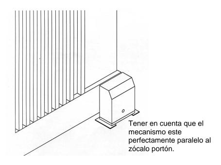
Luego presente un tramo de cremallera sobre el lateral del zócalo, ésta le dará la posición exacta del mecanismo. (Ver Fig. N°4)
