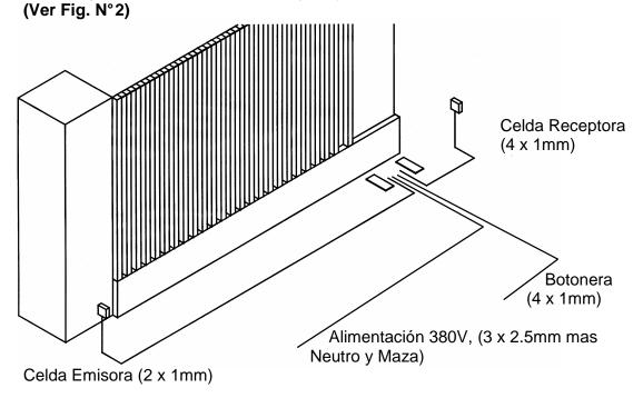
Para el caso de las celdas Fotoeléctricas las cajas deberán ir amuradas a una distancia de 50mm con respecto a la hoja del portón y a una altura de 500 a 600 mm del nivel de piso (para dicha altura hay que considerar que éstas sean interrumpidas por todos vehículos que ingresen); las cajas deben estar perfectamente enfrentadas entre sí para el correcto funcionamiento de las mismas.
