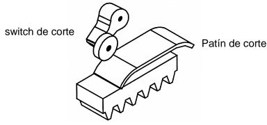
Luego soldar la base de los mismos y aflojar los tornillos de fijación para deslizarlos a la posición correcta de corte, para la apertura y también para el cierre.
